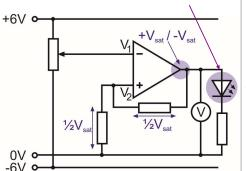
Lights when  $V_2 > V_1$
